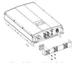
Figure 21 Disassemble the fan box
